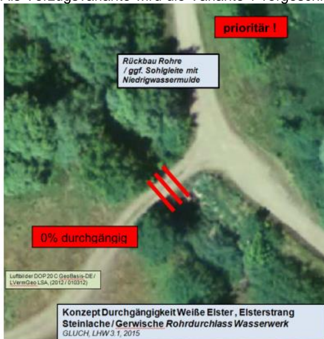
Abb. 5: Konzept Durchgängigkeit Weiße Elster, Elsterstrang steinlache/ Rohrdurchlass südl. von Beesen
